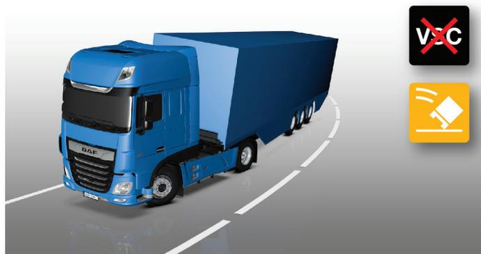
Em caso de subviragem, a parte dianteira do veículo desliza para a extremidade exterior da curva e, se a subviragem não for corrigida, o veículo irá abandonar a estrada. O VSC aplica os travões às rodas interior da curva para fazer o tractor regressar ao percurso pretendido.
